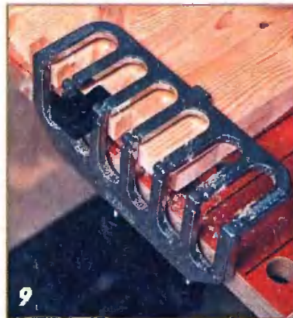
9 Если заготовка шире шаблона, последний переставляют с помощью небольшого пластикового шипа.
