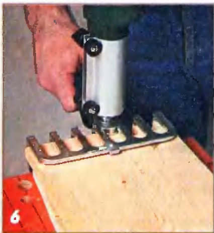
6 При подаче фрезы сверху образуются пазы глубиной 13 мм. При обработке заготовок большей толщины соединения делают вполупотай.
