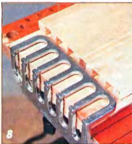
8 При обработке второй заготовки фреза должна подаваться по горизонтали для окончательного формирования шипа «ласточкин хвост».
