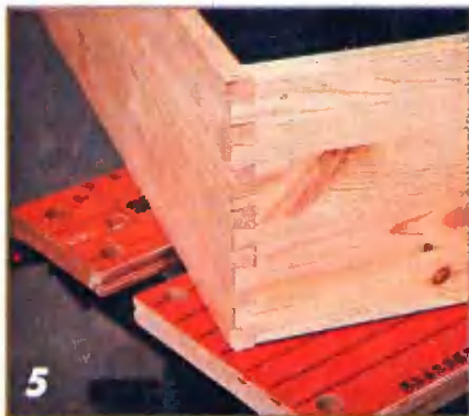
5 Классическое соединение на скрытых шипах «ласточкин хвост» между деталями выдвижного ящика, которое вручную выполнить очень сложно.
