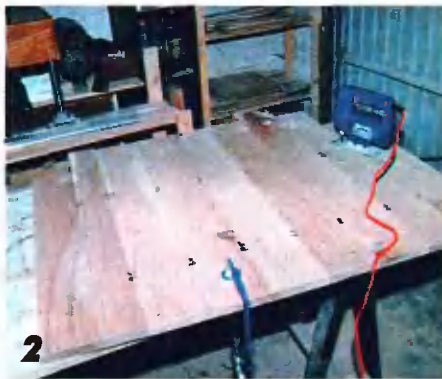
На полученных щитах по шаблону наносят с припуском в 2 мм овальную линию будущей столешницы и опиляют ее электролобзиком.
