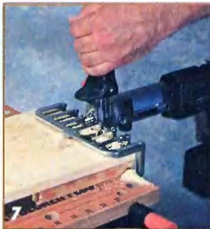
7 Обработанную первую заготовку прикладывают ко второй как при обычном соединении. Теперь можно точно выверить шаблон.
