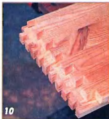
10 Показанное приспособление выпускают в двух вариантах: для нарезки прямых шипов или шипов «ласточкин хвост».
